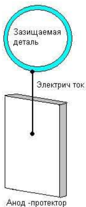
Рис 9.2. Протекторная защита от коррозии.
