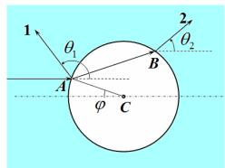
Также падающий луч преломляется на поверхности пузыря, проходит внутри пузыря (отрезок AB) и выходит из него, образуя луч 2. Обозначим угол отклонения этого луча  $\theta_2$ .
